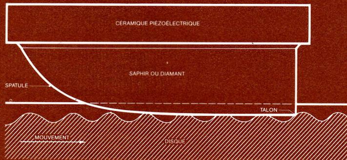
STYLET DE LECTURE UTILISÉ PAR LE SYSTEME MÉCANIQUE TELDEC
