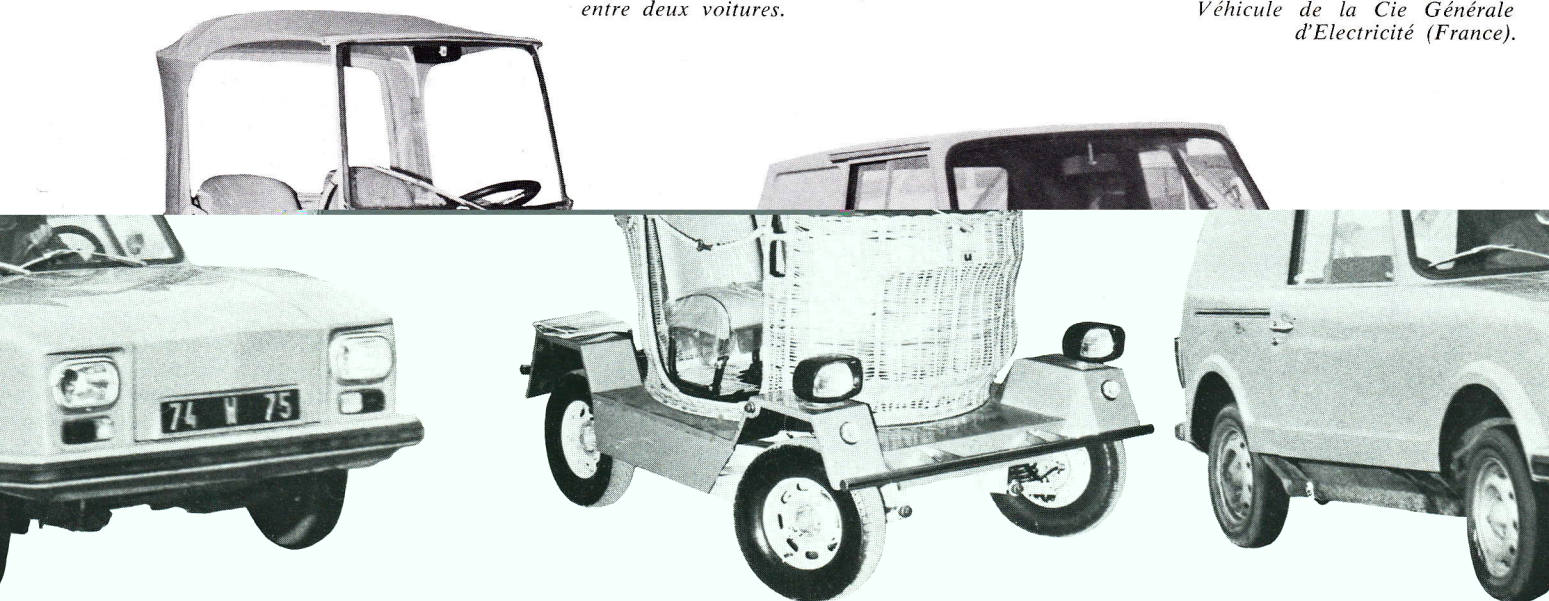
Véhicule Urbanina (Italie), 2 places. A l'arrêt, la cabine peut pivoter, le châssis étant fixe, ce qui permet l'entrée et la sortie du véhicule garé perpendiculairement au trottoir entre deux voitures.
