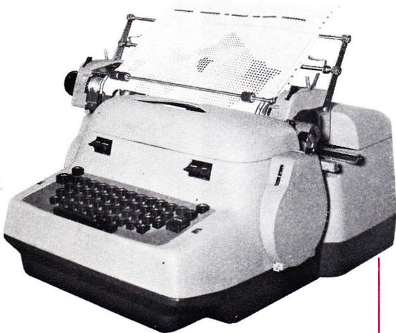
*L'unité d'impression, une machine à écrire adaptée pour la frappe des points, est couplée ici avec un lecteur de cartes perforées.*
