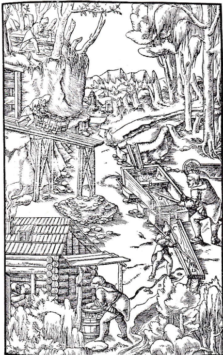
De re metallica (1556) : mine d'étain et récupération du minerai par lavage - Agricola.
