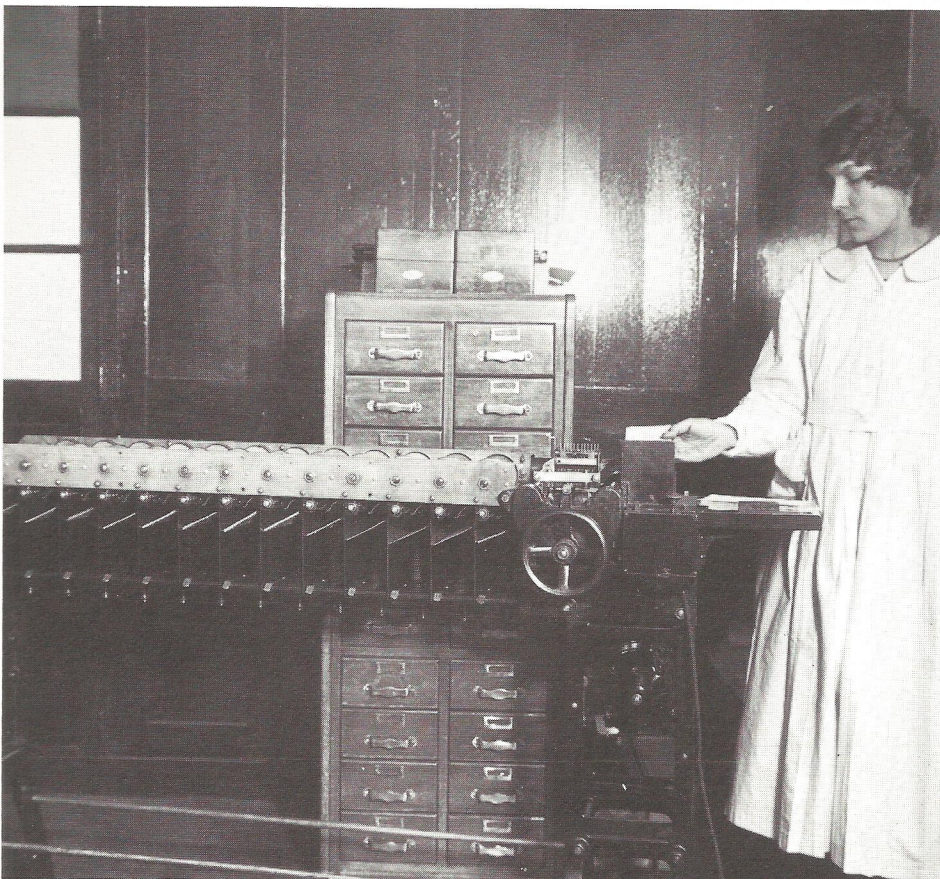
Machine automatique de comptabilité. Trieuse classant des fiches (1921).
